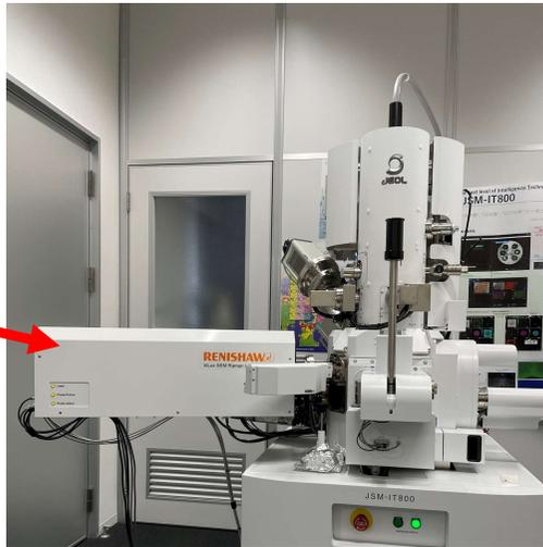
ProbeをSEMの対物レンズの真下に挿入できるため、試料ステージを移動する必要はなし。同軸上でSEM観察とRaman測定が可能。
